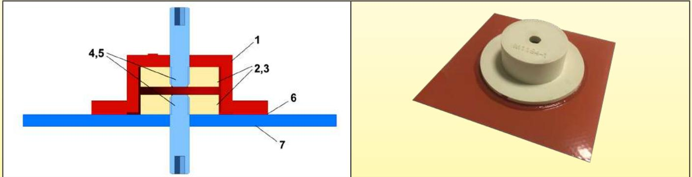
Equipo utilizado para pruebas comparativas (Superficie de unión: 10 cm<sup>2</sup>).
