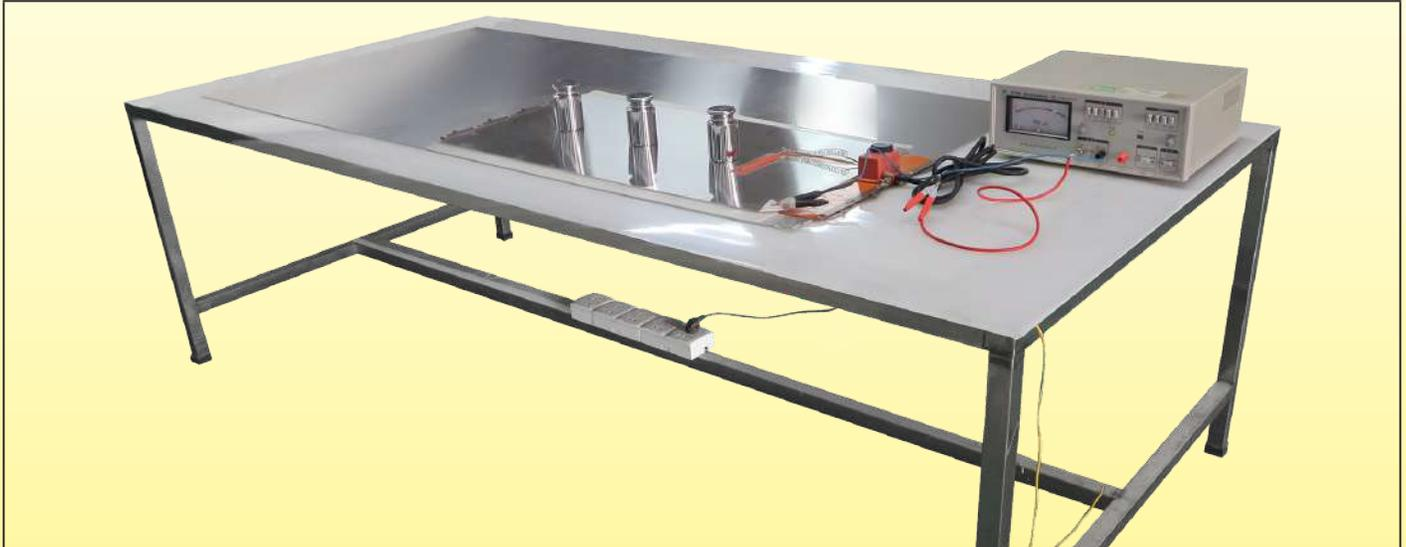
Dispositivo para medir la resistencia de aislamiento.
