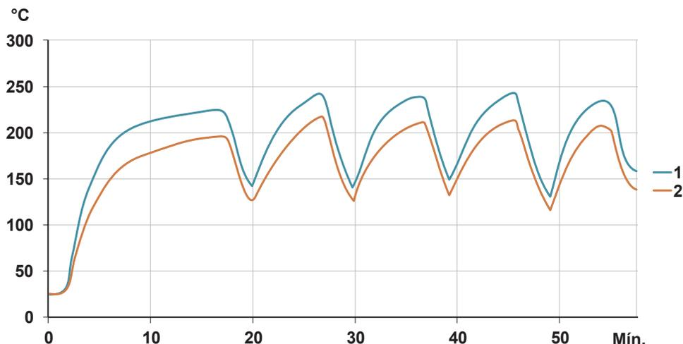
Medición de temperatura realizada en una cinta de silicona de 200 mm de ancho montada en un tambor de 55 galones (200 litros). Potencia de 2250 W (0,75 W/cm<sup>2</sup>), controlador PID con sensor ubicado en el centro del tambor vacío. Temperatura superficial limitada a 190 °C por un termostato de disco.
