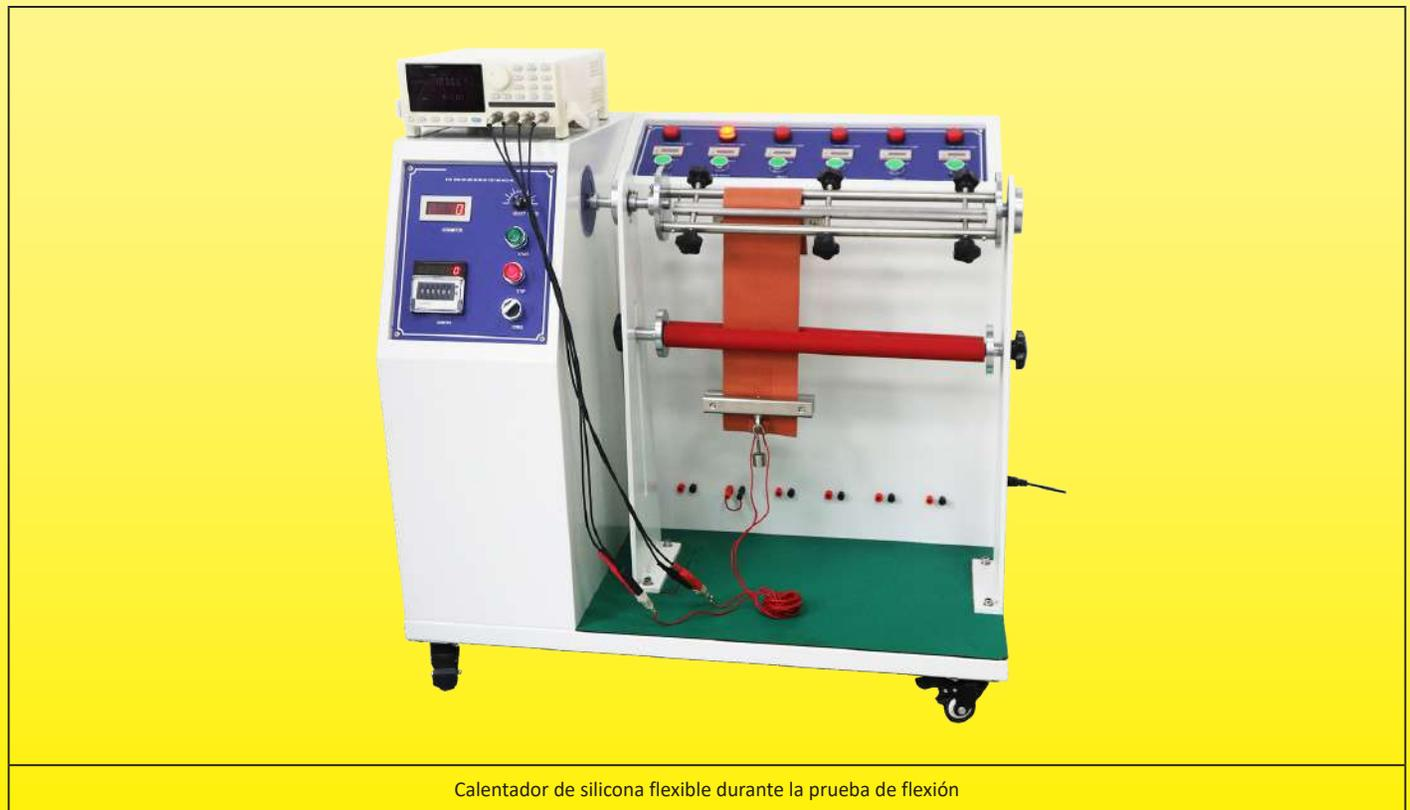
Calentador de silicona flexible durante la prueba de flexión
