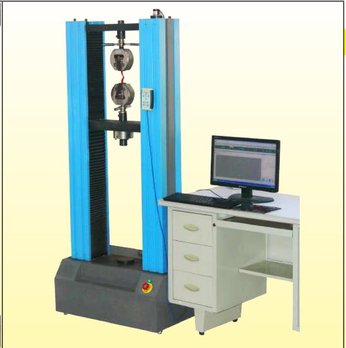
Equipo de prueba de resistencia a la rotura
