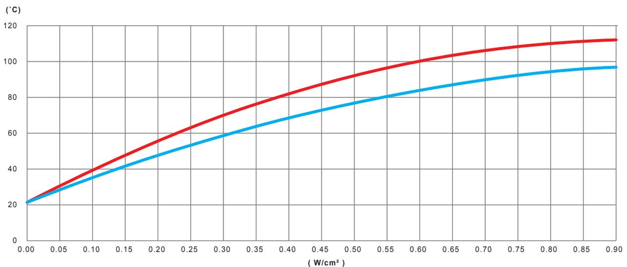
Variación, en función de la potencia en W/cm<sup>2</sup> de la cinta calefactora de silicona, de la temperatura de la pared de un tubo de acero inoxidable lleno de agua no circulante, no aislado térmicamente
